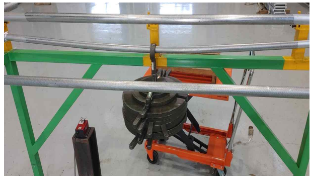
(d) 상부난간 휨강도 시험 사진(2)
