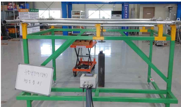
(a) 상부난간 수직처짐 시험 준비 사진
