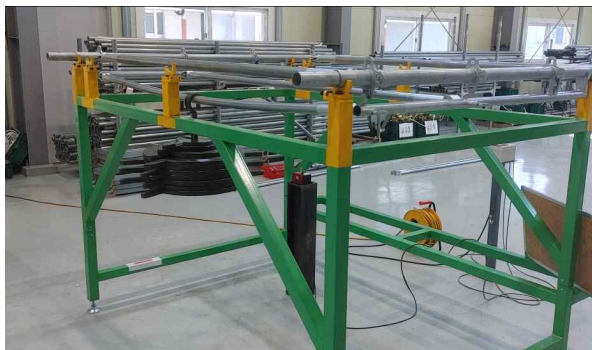
(c) 상부난간 휨강도 시험 사진(1)
