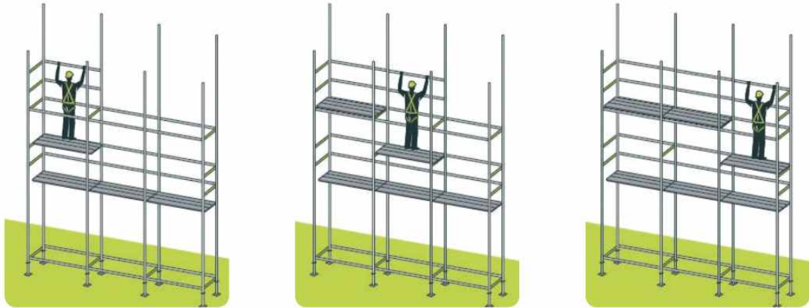
[그림 9] 임시발판을 이용한 순차적 안전난간 선 설치 방법
