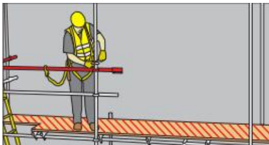
(1단계) 기존 안전난간 위에 클램프(2개) 설치
