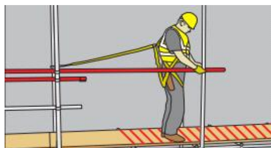
(2단계) 임시 안전난간용 비계를 수평으로 밀어 설치할 수 있도록 클램프에 거치 * 비계가 클램프에서 탈락되지 않도록 조치
