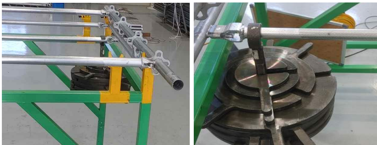
(a) 체결부 휨강도 시험 전경
