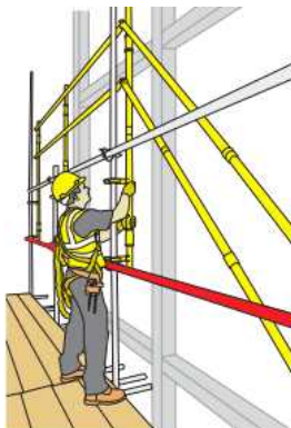
[그림 7] 텔레스코픽 타입(상승식) 안전난간 선 설치 방법
